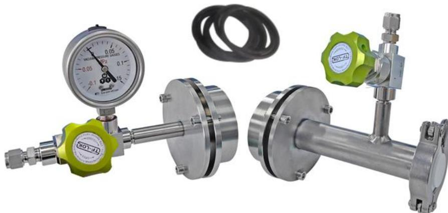
此款为钛合金真空法兰。该法兰作为多种炉子的标配法兰，有多种型号可选。在没有任何焊接和黏合的情况下，拧紧法兰上的螺丝即可使管子密封。全部接头为 316 不锈钢材质，多重接头方案可选
