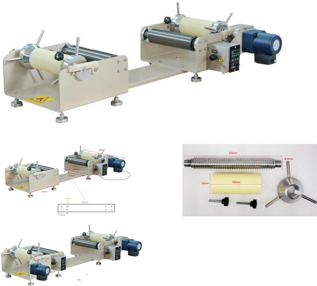
MSK-HRP-04-RD 是一款自动卷对卷系统，设计用于连续收放柔性基材，宽度 $\leq 200\text{mm}$ 。此款产品可以与本公司的小型辊轧机组合，可对箔材进行连续轧制或复合。设备采用力矩电机，张力可调节，运行是保持基材表面张力恒定。
