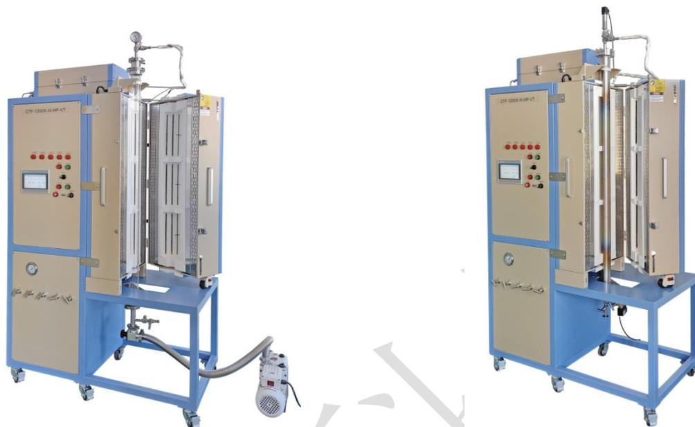
OTF-1200X-III-HP-VT 是一款竖式固定流化床，最高温度 1200℃，配置石英和镍基合金钢两种材质的炉管，可实现高碳水比的甲烷重整制氢和干法天然气重整制氢，配置镍基合金钢管，系统最高承受压力可达 2.5MPa。
