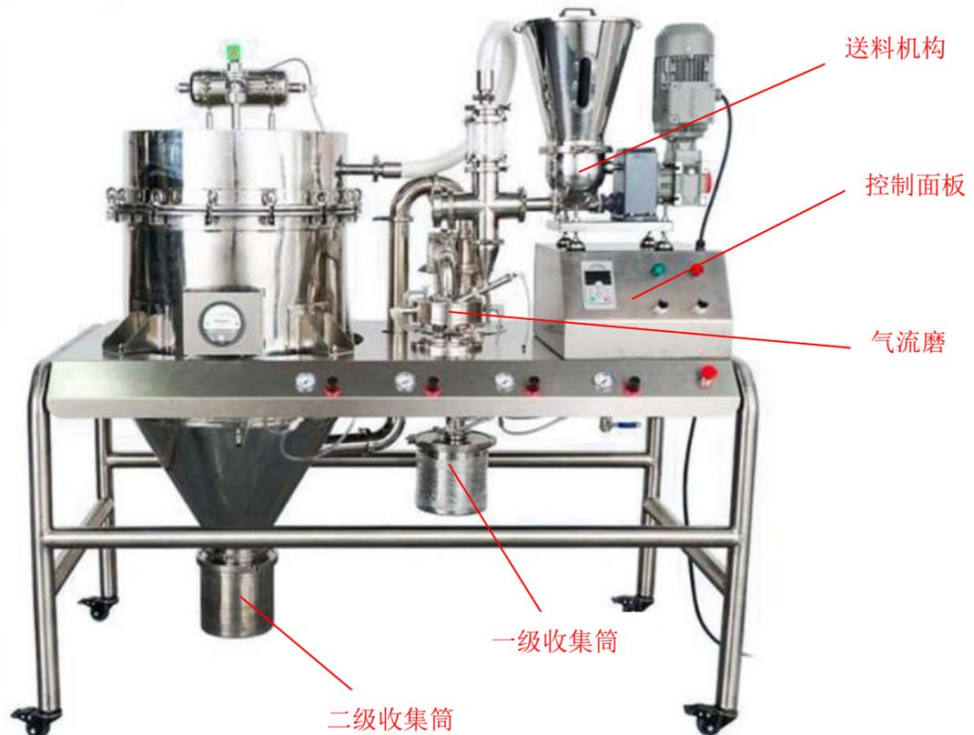
MSK-SFM-AF100 是一款中式型气流磨系统，用于各种硬度和属性材料细化，如陶瓷，磁性材料，铁氧化物和金属合金等，可细化到微米或亚微米级别，也可对干法电极原材料进行纤维化。设备出料速率约 100~2kg/hr。出料端安装有双级的旋风收集系统，可对粉体按照不同的粒径进行 2 级收集，集中粒度分布。
