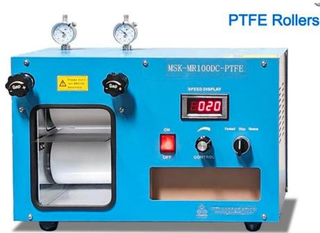
MSK-MR100DC 是一款小型电动辊轧机，采用 24V 直流电机驱动，可在 Ar 环境下的手套箱内使用，轧辊储存为  $\Phi 100 \times 100\text{mm}$ 。此款设备特别适合电池电极的制作，在电极涂布和烘干后进行轧制。
