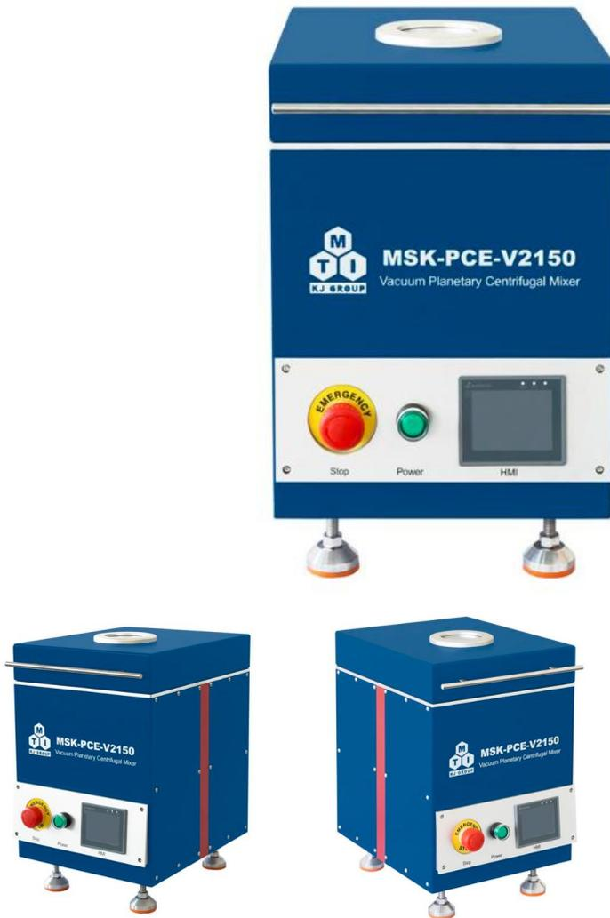
MSK-PCE-V2150 是一款小型的真空行星式离心混料机用于混合或脱泡，适用样品有液体，浆料，糊状物和粉末。此款设备部也可用于混合和均质化纳米粉，纳米管，陶瓷粉末，电池粉末/浆料和金属粉末等。
