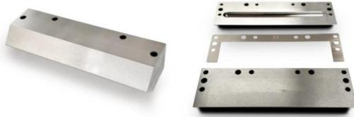
此系列小型实验型挤压头 (slot-die) 可购买标准涂布宽度为 100,150,200,和 300mm(配有不锈钢垫片), 此系列挤压头 (slot-die) 适合于低粘度浆料涂布, 且便于拆卸, 装配和清洗。涂布速度一般为 0.1-5m/min 此系列挤压头 (slot-die) 非常适合于实验室 DIY 一套廉价的挤压涂布设备。
