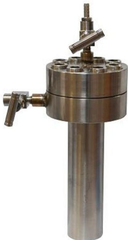
RC-Ni-V 是一款小型水热反应器，采用镍基合金钢制作，有极好的蠕变强度和抗氧化性。反应器能达到 4MPa(O<sub>2</sub> 或惰性气体)，可承受温度 1100℃。此款产品特别适合使用水热法来制备先进材料，特别适合需要在高压氧环境下处理的样品。
