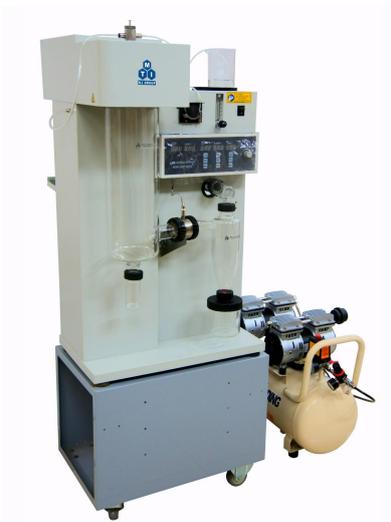
MSK-USP-6000 是一款实验型雾化干燥器，通过蒸发雾化液滴以及旋风分离工艺进行微粉的制备收集。该设备对温敏型材料具有广谱适用性，广泛应用于生物医药、纳米技术、催化剂、燃料电池以及其他电池领域。
