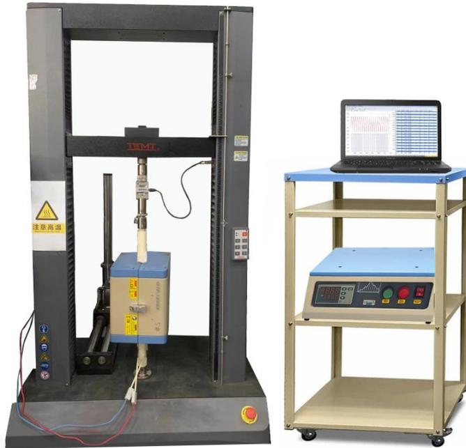
高温力学测试系统主要应用于对材料或部件进行拉伸、挤压、弯曲、剥离、撕裂等力学试验, 可求出试验最大力、抗拉强度、弯曲强度、挤压强度、弹性模量、屈服强度等参数。应用覆盖金属、非金属、复合材料、航空和冶金、汽车制造、电力电子等领域。整体系统主要包括加热炉和万能试验机两个部分组成。(图片仅供参考, 请以实物为准)
