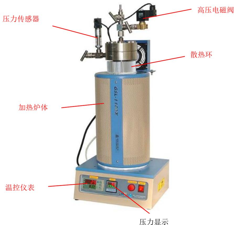
GSL-1100X-RC-NI300 是一款 300ml 的立式高温高压反应釜，材质为镍基合金钢，具有特别好的蠕变强度和抗氧化性。设备最高使用温度 1100℃，此温度下最大气压 3MPa(氧或惰性气体环境)。这个高温高压反应釜非常适合用水溶液发合成探索新材料，也可对一些材料在高压氧环境下热处理。同时也可作为蒸汽发生器使用。
