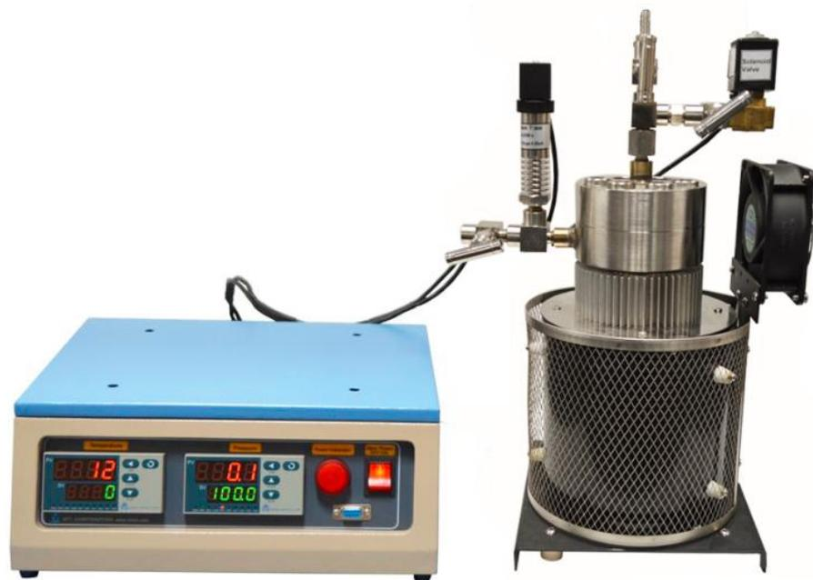
GSL-1100X-RC 是立式高温高压反应釜，材质为镍基合金钢，具有特别好的蠕变强度和抗氧化性。设备最高使用温度 1100℃，此温度下最大气压 4MPa(氧或惰性气体环境)。这个高温高压反应釜非常适合用水溶液发合成探索新材料，也可对一些材料在高压氧环境下热处理。同时也可作为蒸汽发生器使用。
