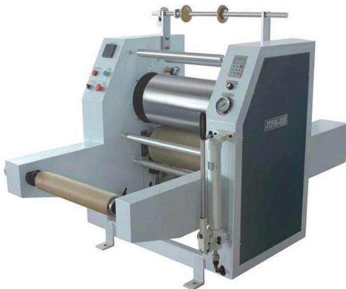
JTFM-XXX 是一款加热温度为 130℃ 的双面层压机器，可以用以层压复合多层箔材，带有手动液压泵，最大压力 1.2T, 可选宽度：340mm, 480mm 和 1000mm。此款设备特别适合用于探索多层 LCP(液晶聚合物膜)，柔性电子器件和固态电池等。
