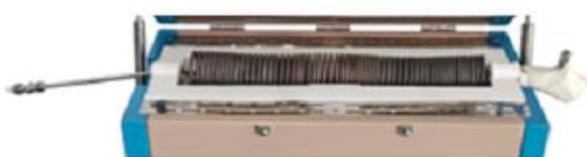
OTF-1200X-NS-FB 是一款 3 温区 (1200mm L) 管式反应器, 最高工作温度为 1000℃, 最大可承受气压为 25MPa(和使用温度有关)
