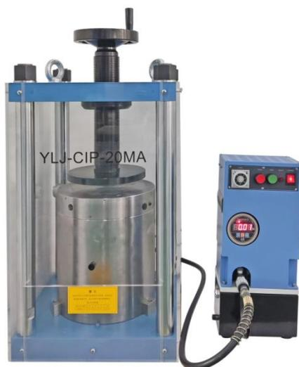
YLJ-CIP-20MA 是一款电动压力机，将样品放置于盛满液体的超强合金密封容器中，用电动液压泵施加压力，压强最大可达到 20MPa，实时压力可在压力表上显示，并安装有防护罩，确保了实验的安全性。可广泛用于粉末冶金、复合材料、耐火材料、陶瓷、硬质合金等材料的成型制备
