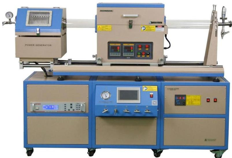
OTF-1200X-II-80-4CLV-PE (带滑轨) 是一款滑动式双温区 PECVD 管式炉系统。该系统包含等离子射频电源, 双温区滑轨炉, 4 通道质量流量供气系统和机械泵机组, 可用于生长纳米或石墨烯材料。
