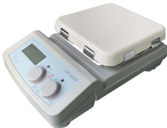
SP-H550 是一款通过 CE 认证的热偶外置式加热型磁力搅拌器，通过 LCD 屏可设置和显示转速、温度。配有外置温度传感器 PT1000，可实时反馈样品实际温度。此款设备最高加热温度可达到 550℃。本仪器是为学校、实验室和工厂等应用环境设计的，用于对液体进行加热及搅拌。
