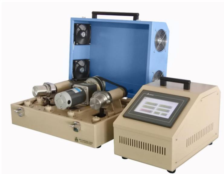
MSK-SFM-3-II 是高速三维摆振球磨机 MSK-SFM-3 的升级版，可一次性放置两个球磨罐进行球磨，球磨容量达 160ml，球磨速度可调，最大转速达 1000rpm，球磨电机采用 24V 直流电机，可放置于手套箱中进行氧敏感性材料的球磨实验。
