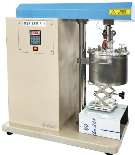
MSK-SFM-3LN 是一款采用液氮冷却的搅拌研磨机，可用于研磨常温下柔软、韧性好的材料，罐体温度可低至-150℃。
