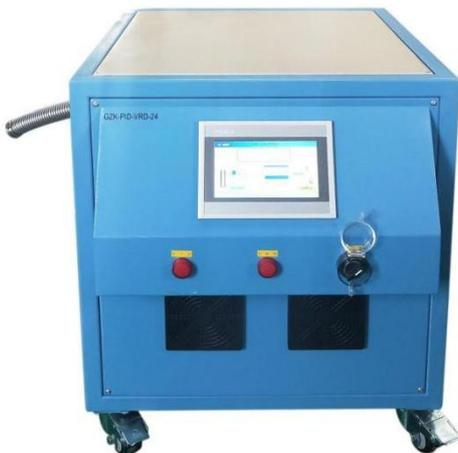
GZK-PID-VRD24 恒压系统通过 PID 控制真空泵的转速来控制抽气速率，进而获得腔室压力的精密测量和恒压控制，与我公司的管式炉/镀膜仪等设备相结合，实现 CVD、PECVD 等工艺的压力恒定的精确控制，广泛用于扩散、氧化、外延、CVD、等离子溅射以及镀膜工艺、混气配气系统及其他分析仪器中。
