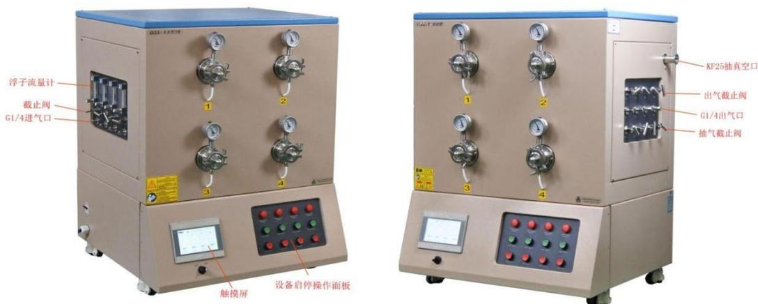
GSL-1500X-MGI-4 是一款 1500℃ 小型 4 通道管式炉，可用于高通量烧结，最高温度 1500℃。每个加热模块都由独立的温控系统控制，每个炉管采用真空法兰密封，可同时放入 4 个样品，在真空或保护气氛环境下进行不同温度的热处理，占地小，能耗低，对于在材料基因计划中探索材料相图是非常好的实验工具。
