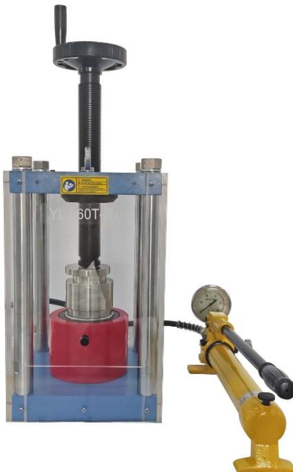
YLJ-60T-SJ 型手动压力机是专门为实验室试样制备而设计的专用压机，配备不同的模具可将各种不同类型的粉状物料制备成具有一定强度和形状的试样，整机设计小巧，使用灵活便捷，非常适用于精密陶瓷、新材料、新能源、超导、建材等领域试样制备及材料成型。为红外分光光度计、X 荧光分析、钙铁分析仪等设备制备粉末压片，也可以用于其他压力实验和加压工作，用途广泛。
