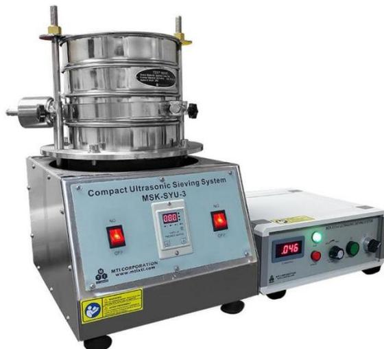
SYU-3 是一款台式振动和超声波筛分系统，内置微处理器。它根据材料的负载调整超声波频率和振动时间。普通过滤系统的筛网容易因静电、内聚力或材料吸附而堵塞。超声波振动可防止筛网堵塞，并以高性能方式生产均匀的产品。
