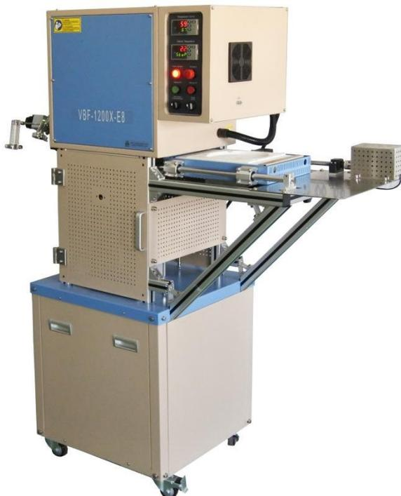
VBF-1200X-E8 是一款可升降的立式气氛管式炉,底部安装有升降台,可实现样品快速气体冷却。可放入样品的最大尺寸为  $\Phi 200*50\text{mm}$ 。样品加热采用 PID 方式控温,可设置 30 段升降温程序。
